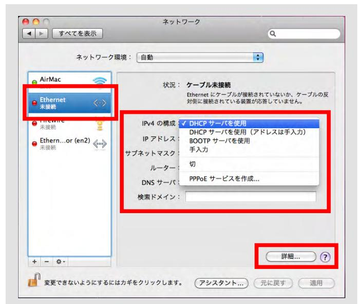
4) 「TCP/IP」タブを選択し、IPv4 の構成を「DHCP サーバを使用」を選択します。
